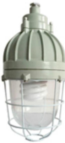
Ⅱ类非矿用防爆电气设备90%是用于石油、海洋石油、石油化工、化学工业和制药等行业（简称石化行业），这些行业中的危险化学品作业场所存在的易燃易爆气体/蒸气种类繁多，生产、储存、运输等环节工艺装备复杂多变，释放源种类繁多，危险因素难以分析判定。所以，对防爆电气设备的选型、安装和使用维护比矿用防爆电气设备要复杂的多。一要满足危险场所划分的危险区域来选用相应的电气防爆类型；二要根据危险环境可能存在的易燃易爆气体/粉尘的种类来选择防爆电气设备的级别和温度组别；三是考虑其他环境条件对防爆性能的影响（例如：化学腐蚀、盐雾、高温高湿、沙尘雨水，或振动的影响）；四是保证安装使用维护的特殊性；五是选用具有防爆合格证以及国家相应认证的产品。
