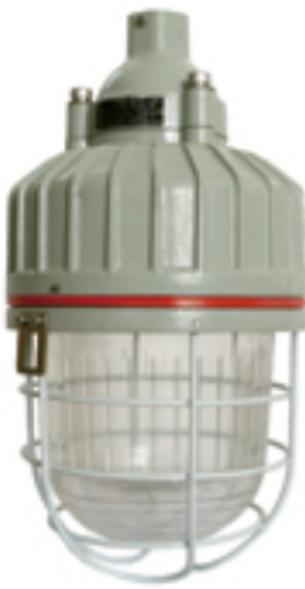
一般隔爆型灯具透明件采用密封结构时，密封垫的厚度须不小于 $2.0\text{mm}$ 。金属外壳与玻璃透明件之间密封垫的嵌入部分宽度，须不小于 $10.0\text{mm}$ 。同时玻璃透明件一般应以内腔安装，因为当内部有压力时，弹性密封垫趋于压缩状态，会加强密封性能。弹性密封垫的材质，一般采用丁腈橡胶；当灯具的功率较大时，可采用石棉橡胶板或硅橡胶、氟橡胶等离火自熄的材料。还必须注意的是，在安装玻璃透件时，就采取措施，从结构上保证压紧灯罩、玻璃管、透明板的周边，受力要均匀，避免引起透明件内部产生危险的机械应力。对于隔爆型灯具的玻璃透明件，还可以采用与外壳灯体直接胶封的方法密封固定。这种结构对胶封材料要求较高，以硅橡胶为宜。灯具透明件与外壳部件的固定，在结构上必须保证，在更换光源时，透明件和密封件不得从外壳部件上脱落。河南粉尘防爆灯具江苏天堡从业防爆灯具设备，经验丰富，深受客户好评。
